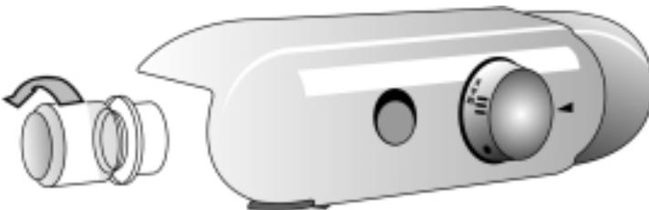
Drehen Sie die Glühlampe wie in der Abbildung gegen den Uhrzeigersinn heraus.
